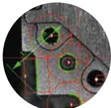
Medição do diâmetro da erosão.
